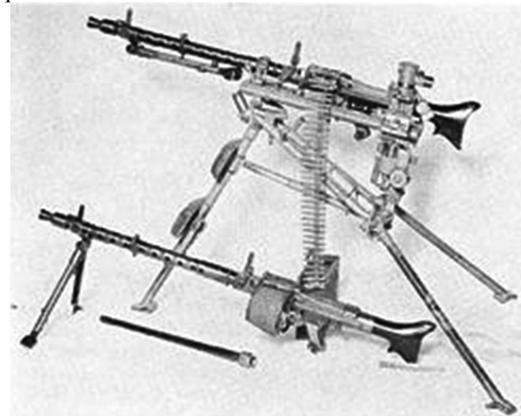
**MG-34: вариант на станке с ленточным питанием, и на сошках с магазинным питанием. На станочный вариант установлен оптический прицел. Под «сошником» лежит снятый ствол. Надпись под рисунком по-немецки: «Модель 18-МГ34 (Солотур) 7,92-мм взаимозаменяемый -унифицированный выстрел».**
